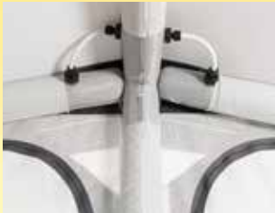
Verbinding tussen de luchtslangen
